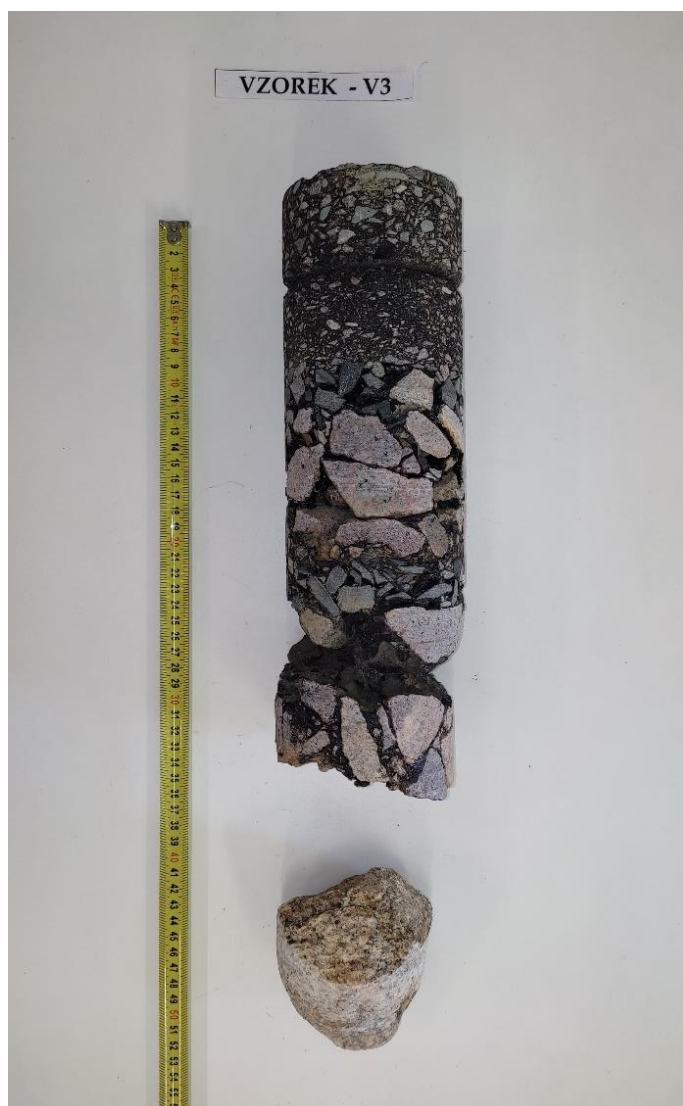
Obr. 6 - Jádro vývrtu Vzorek – V3 (laboratoř).
