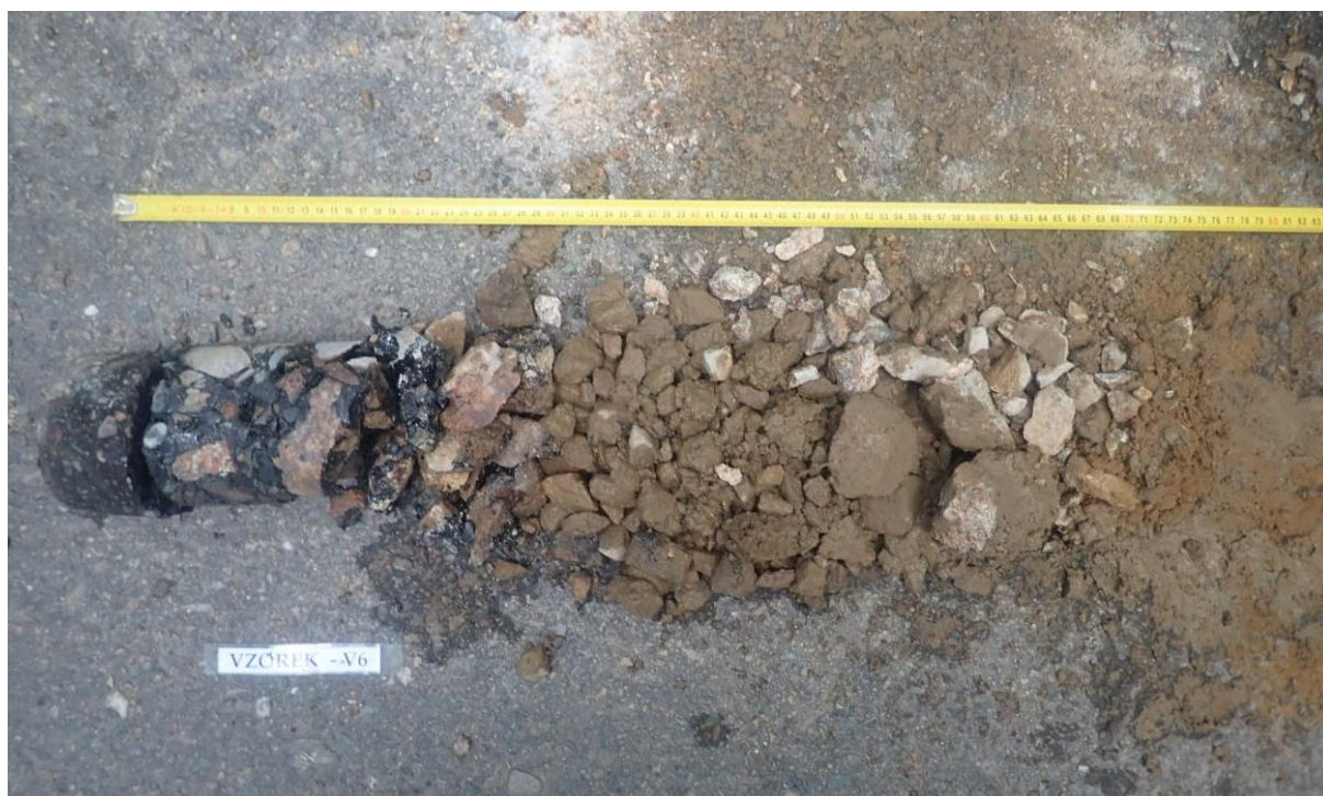
Obr. 11 - Jádro vývrtu Vzorek – V6 (in situ).
