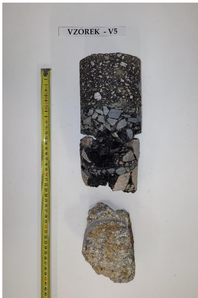
Obr. 10 - Jádru vývrtu Vzorek – V5 (laboratoř).
