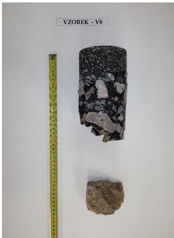
Obr. 12 - Jádru vývrtu Vzorek – V6 (laboratoř).
