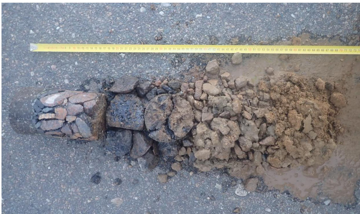
Obr. 1 - Jádro vývrtu Vzorek – V1 (in situ).
