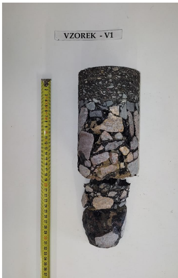
Obr. 2 - Jádru vývrtu Vzorek – V1 (laboratoř).
