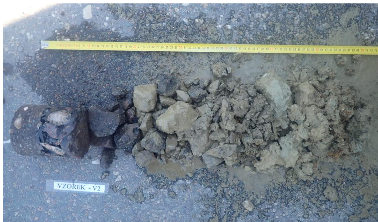
Obr. 3 - Jádro vývrtu Vzorek – V2 (in situ).
